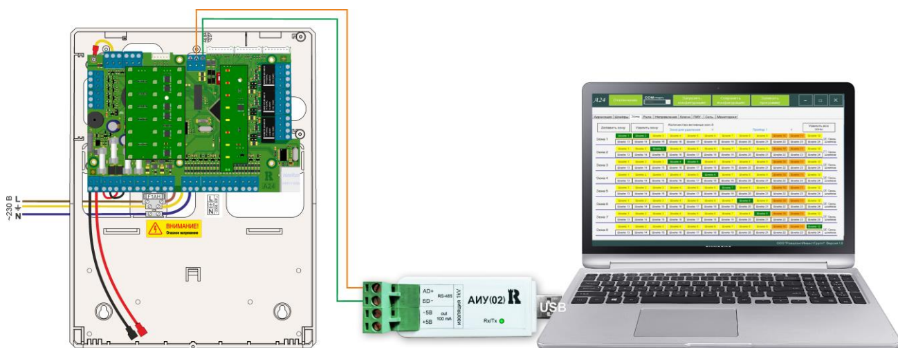
Рисунок 134. Схема подключения для конфигурирования ППКПиУ А24
