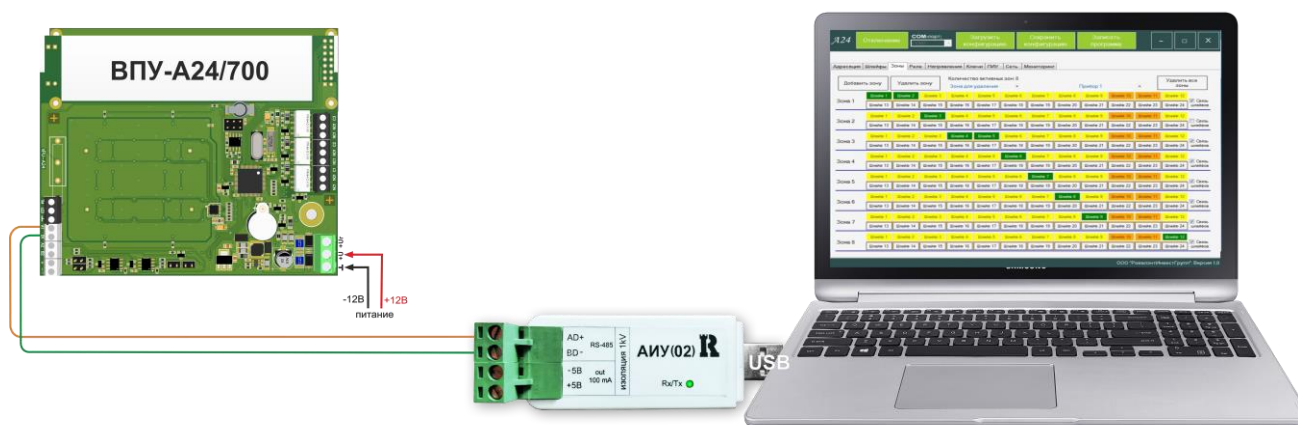
Рисунок 133. Схема подключения для конфигурирования ВПУ-А24/700
